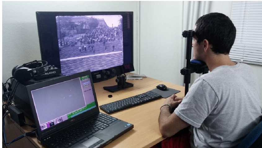
Fig. 2. Experimento de seguimiento ocular con el equipo Eye Link 1000 Plus de SR Research (de hasta 1000 muestras por segundo), Laboratorio de Arte Electrónico e Inteligencia Artificial UNTREF. 1
